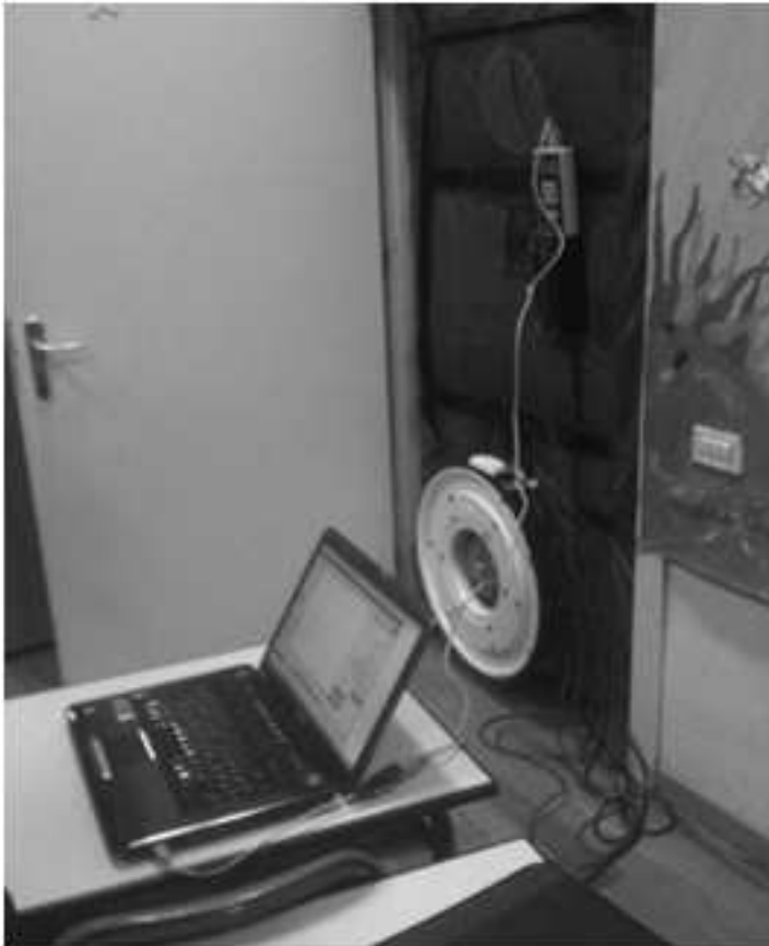
La foto mostra l'apparecchiatura montata sul foro della porta
