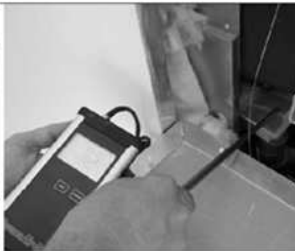
5. sifone aperto dell'impianto di climatizzazione 0,9 m/s
